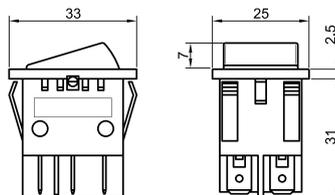
Comando bipolare per dima 22x30mm
