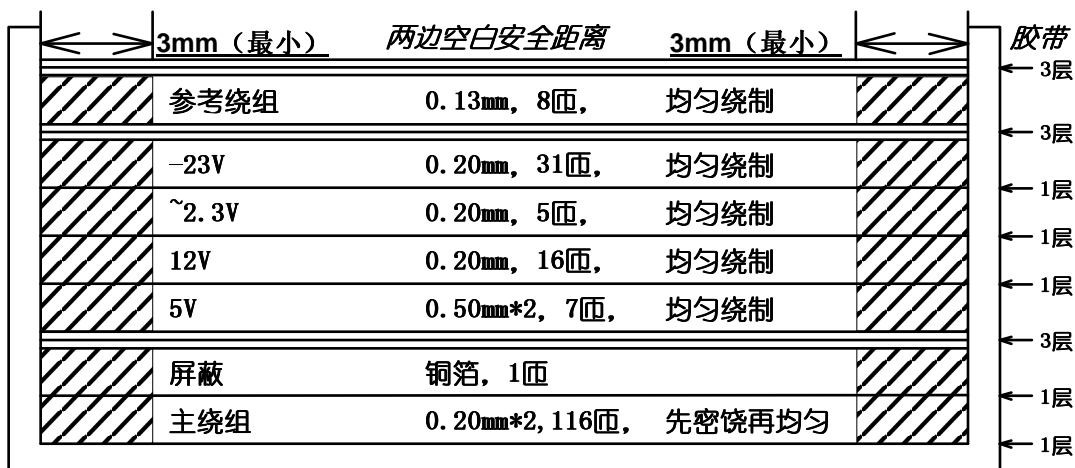
图 5、例 2, T1,EEL19,1mH 变压器结构
